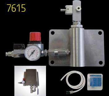
По запросу: Корпус, код 76XX: СА. Бай-пасс, 76XX: ВҮ Корпус и бай-пасс, код 76XX: СА ВҮ Для бай-пасса (76XX ВҮ о 76XX СА ВҮ) с 4904F омывающей форсункой 4803 Пенообразователь низкого давления из нержавеющей стали с инжектором из нержавеющей стали, входное давление 2,5 бар (макс. 10 бар, 50°С). С калиброванными жиклерами. Необходим сжатый воздух 100 л/мин, 3-6 бар. Минимальный внутренний диаметр шланга 19 мм
