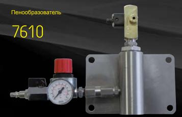
Пенообразователь низкого давления из нержавеющей стали, с бронзовым инжектором и форсункой ST/ST, минимальное входное давление воды 2,5 бар (макс. 10 бар 50°С). В комплекте с измерительными наконечниками. Необходим сжатый воздух 100 л/мин, 3-6 бар. Минимальный внутренний диаметр шланга 12,5мм
