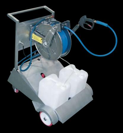
Усиленная тележка из нержавейки с автоматическим барабаном AV 1000, голубым шлангом высокого давления, фитингами из нержавейки, системой пенообразования с байпассом 7650 ВУ, пистолетом 7016, муфтой 4904 гайка, копьем 7433, копьем 7431, насосом высокого давления 100 бар, 12 л/мин.
