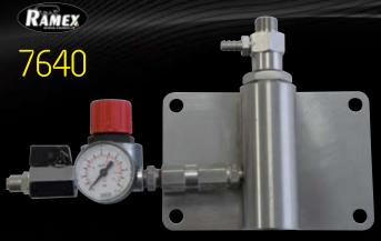
Пенообразователь низкого давления из нержавеющей стали с инжектором из нержавеющей стали, входное давление воды 4 бар (макс. 10 бар, 60°С). С калиброванными жиклерами. Необходим сжатый воздух 100 л/мин, 3-6 бар. Минимальный внутренний диаметр шланга 19 мм
