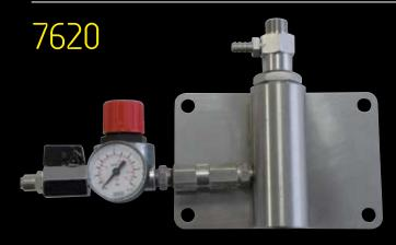
Пенообразователь среднего давления из нержавеющей стали с инжектором из нержавеющей стали. Минимальное давление воды на входе 15 бар (макс. 20 бар, 60°С). Калиброванные форсунки. Необходим сжатый воздух 100 л/мин, 3-6 бар. Минимальный внутренний диаметр шланга 12.5 мм
