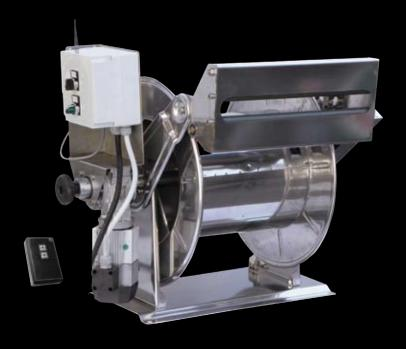
Барабанизнержавеющейсталидляшланга длиной до 100 м и внешним диаметром 20 мм с фронтальным направляющим «бесконечным» винтовым механизмом (только для шлангов высокого давления с внешним диаметром порядка 20 мм), приемным механизмом, блоком контроля, дистанционным управлением, приводом с ограничителем усилия, электромотором 12 вольт IP 54 S2 20' (может использоваться вне помещений без дополнительного укрытия).
