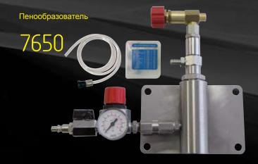
Пенообразователь высокого давления из нержавеющей стали с инжектором из нержавеющей стали. Минимальное давление воды на входе 50 бар (макс. 120 бар, 60°С). Калиброванные форсунки. Необходим сжатый воздух 100 л/мин, 3-6 бар. Минимальный внутренний диаметр шланга 12.5 мм
