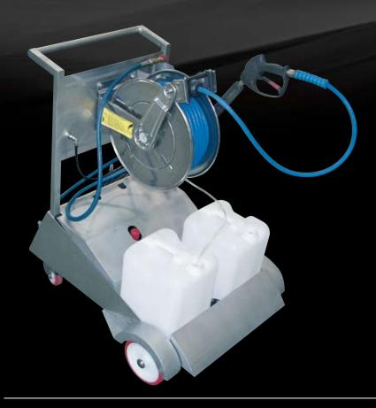
Усиленная тележка из нержавейки с автоматическим барабаном AV 1000, голубым шлангом высокого давления, фитингами из нержавейки, системой пенообразования с байпассом 7650 ВУ, пистолетом 7016, муфтой 4904 гайка, копьем 7433, копьем 7431.
