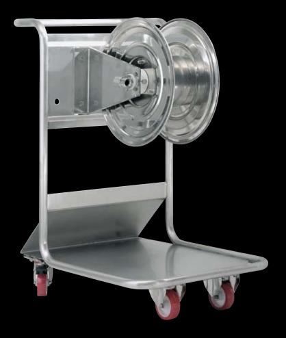
Тележка на 4 колесах из нержавейки для пищевой промышленности (2 фиксированных и 2 поворотных колеса, тормоз) с AVM 9310 для 35 м. 1/2" (размеры: см 70х90х115, 22 кг)
