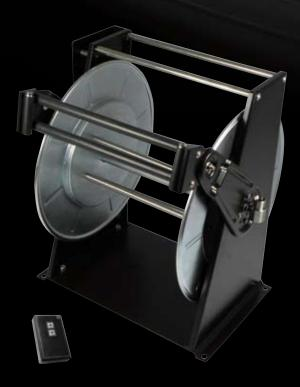
Барабан из нержавеющей стали для шланга длиной до 40 м и внешним диаметром 20 мм с приемным механизмом, блоком контроля, дистанционным управлением, приводом с ограничителем усилия, электромотором 12 вольт IP 54 S2 20' (может использоваться вне помещений без дополнительного укрытия).
