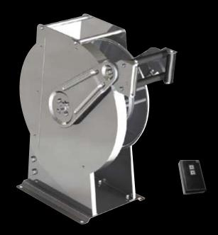
Барабанизнержавеющейсталидляшланга ¼" длиной до 100 м, ресивер, контроль рабочего состояния, дистанционный пульт, мотор с цепным приводом 12 в IP44 (может использоваться без внешнего кожуха).
