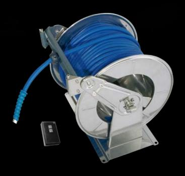
Барабан из нержавеющей стали для шланга длиной до 100 м и внешним диаметром 20 мм с приемным механизмом, блоком контроля, дистанционным управлением, приводом с ограничителем усилия, электромотором 12 вольт IP 54 S2 20' (может использоваться вне помещений без дополнительного укрытия).
