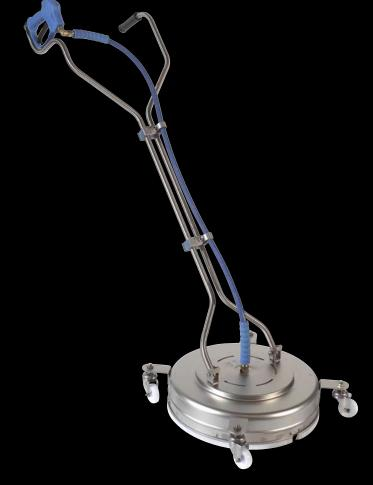
Поломойка высокого давления из нержавеющей стали диаметром 450 мм, рабочим давлением 350 бар и температурой 80°C.
